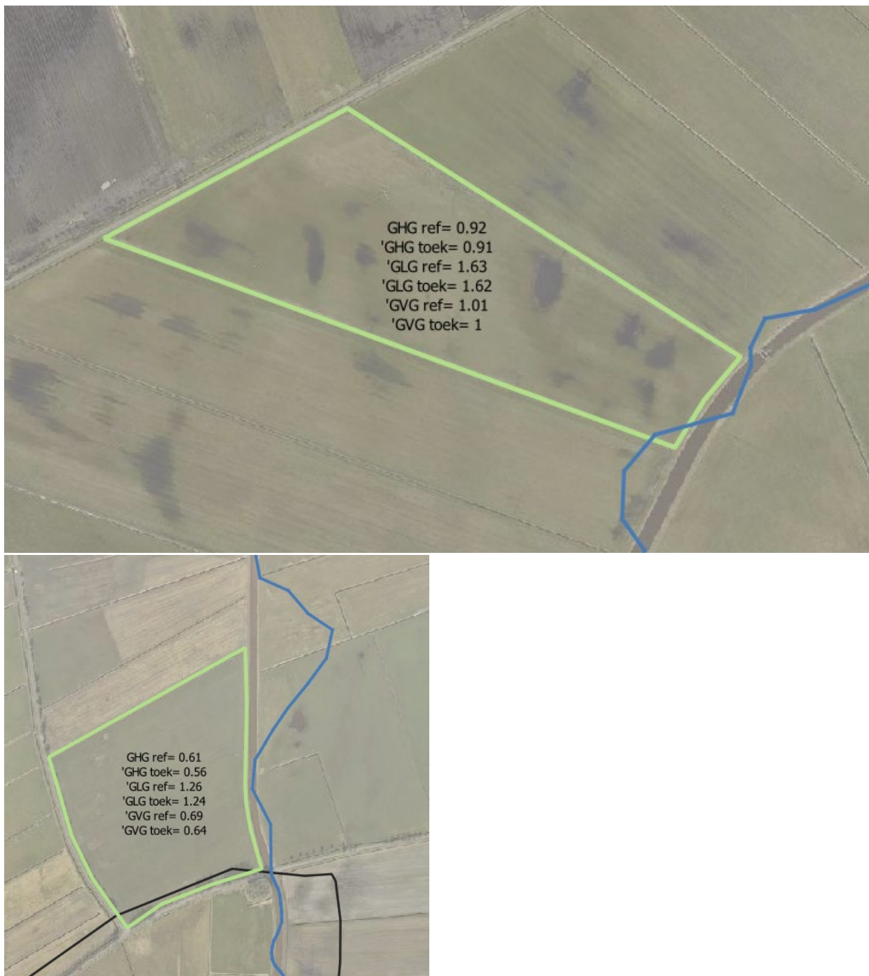
Figuur 6-13 grondwaterstanden binnen de percelen met nog agrarisch gebruik binnen de Branden.
